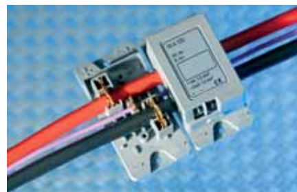
Za razvođenje instalacije Capi-2 postoje posebno prilagođeni razvodnici. Crvena i crna žica služe za napajanje uređaja električnom energijom, dok je ljubičasta namijenjena prijenosu informacija o stanju u mreži i upravljanju pojedinim uređajem
