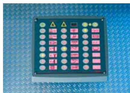
Panel s lampicama koji služi za prikaz stanja navigacijskih svjetala
